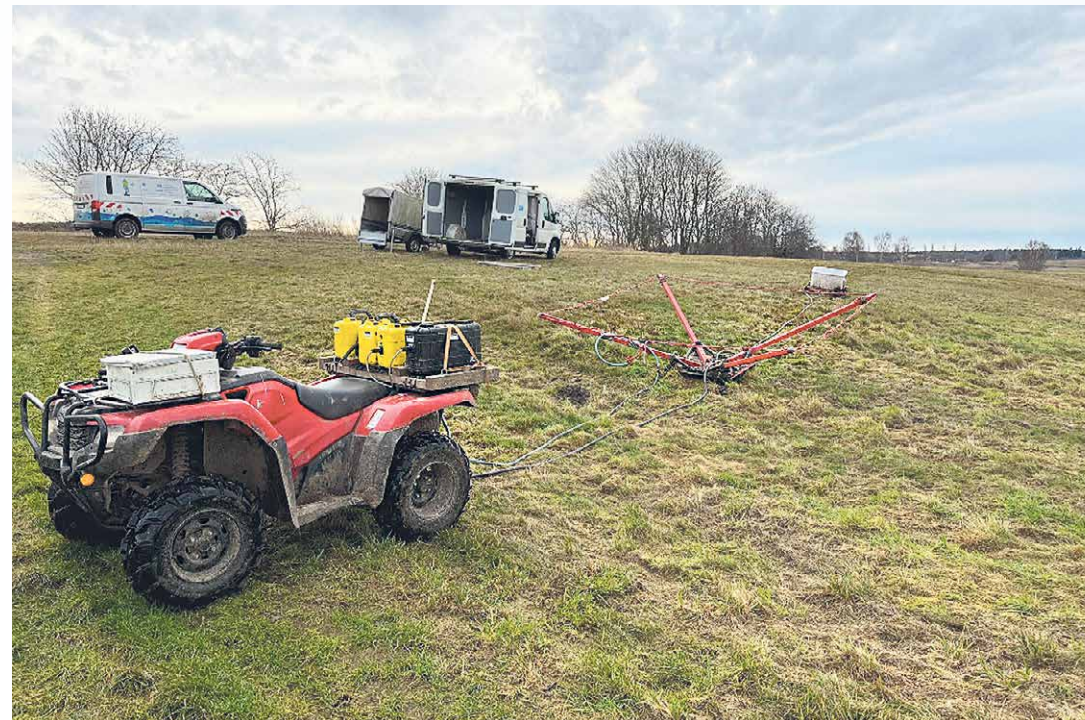
Die Tiefenwasser-Erkundung übernahm die dänische Firma „Ramboll“. Sie brachte dafür ein Quad, eine Sendespule und einen Empfänger mit. Damit fahren die Mitarbeiter über das ausgewählte Areal.
