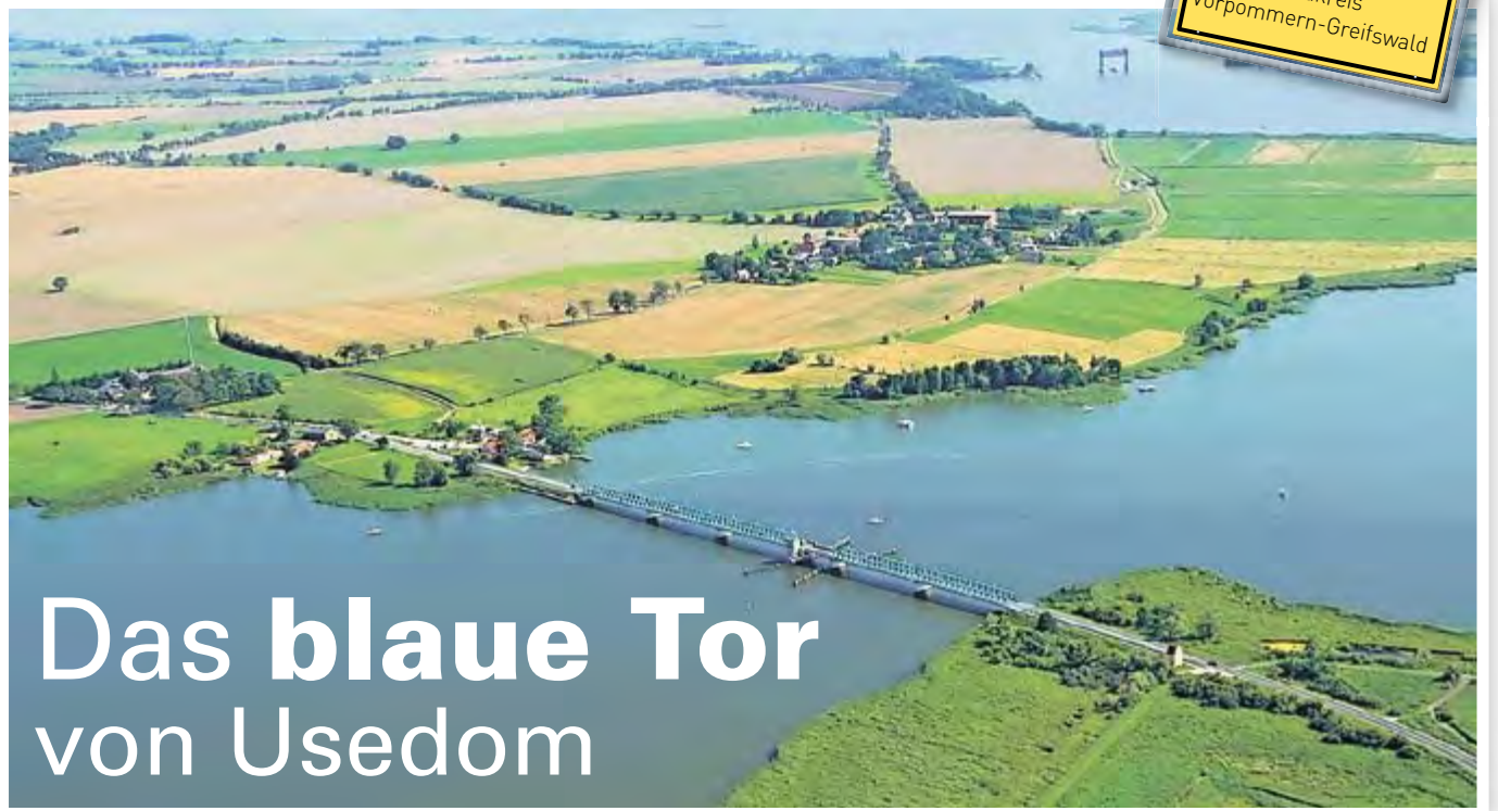
Die erste Zecheriner Brücke wurde 1931 eröffnet, 1945 jedoch von der Wehrmacht gesprengt. Die heutige Brücke wurde 1955 für den Verkehr freigegeben. Sie ist 325 Meter lang, lässt sich auf 20 Metern Länge aufklappen und wurde 1999 komplett saniert. Foto: Zweckverband/Ute Spohler
